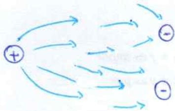
$\vec{E}$ : campo eléctrico en un pto  $(x,y)$  generado por cargas estáticas
